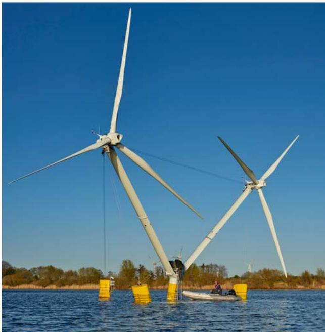
Aufbau und Test des Modells der schwimmenden Windenergieanlage „Nezzy 2“ (Maßstab 1:10) in Hymendorf in Niedersachsen. Foto: Jan Oelker
