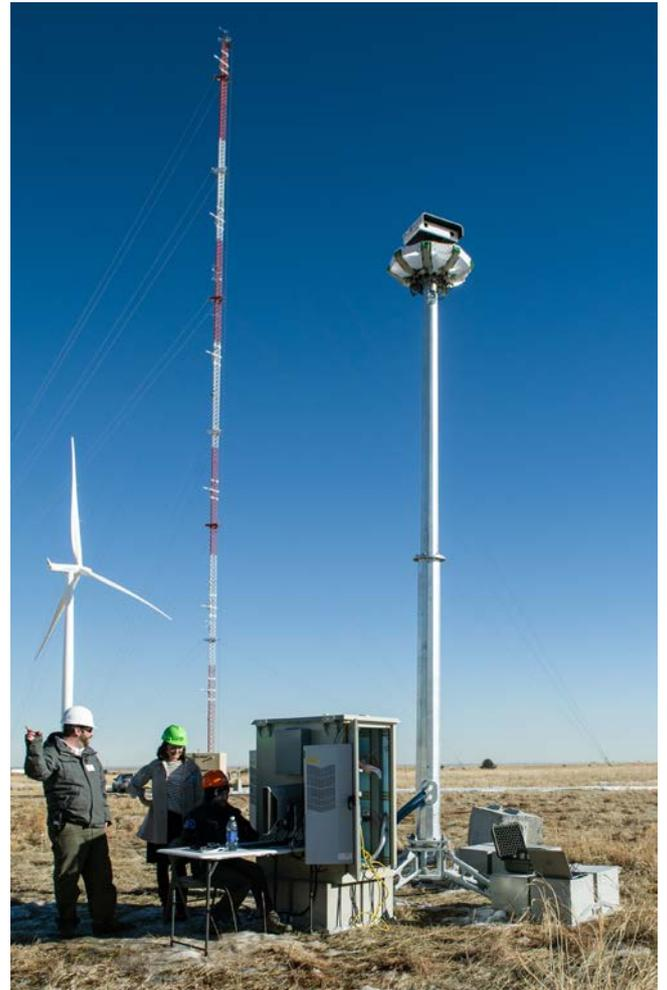
Das Kamerasystem Identiflight kann Vögel nicht nur bis zu einem Kilometer entfernt erkennen, sondern auch die Art identifizieren.
