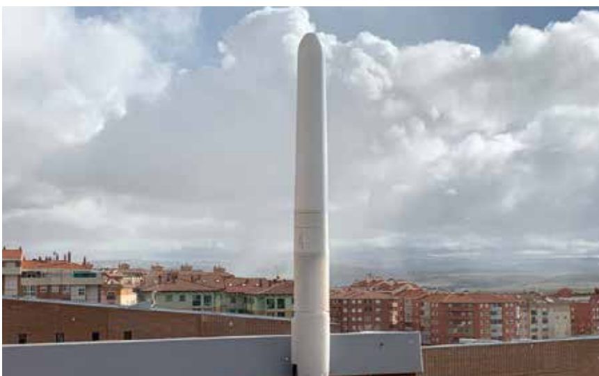
Eine Vortex Bladeless-Anlage produziert Strom auf dem Dach der Universität von Ávila. Foto: Vortex Bladeless
