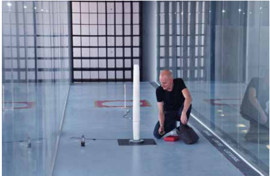
Der Windgenerator wird im Windkanal getestet. Foto: Vortex Bladeless
