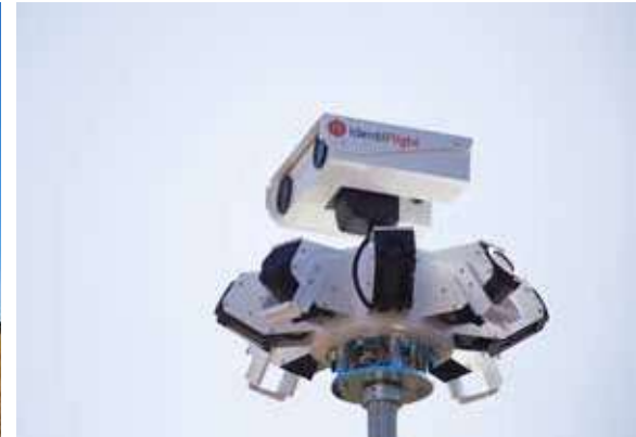
Das Stereo-Kamerasystem IdentiFlight detektiert und erkennt kollisionsgefährdete Brutvogelarten.
