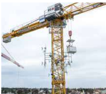
Windkraftanlagen am Baukran der SÜBA AG in Stockerau
