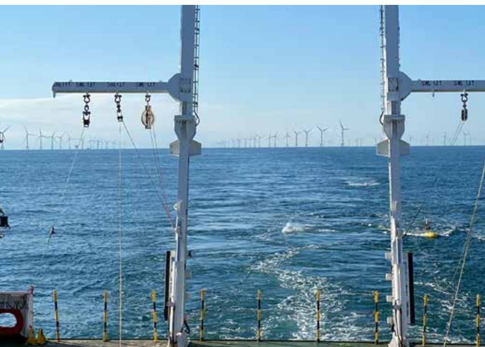
Fugro Pioneer mit seismischer Ausrüstung bei der Durchführung einer geophysikalischen Untersuchung. ©Fugro
