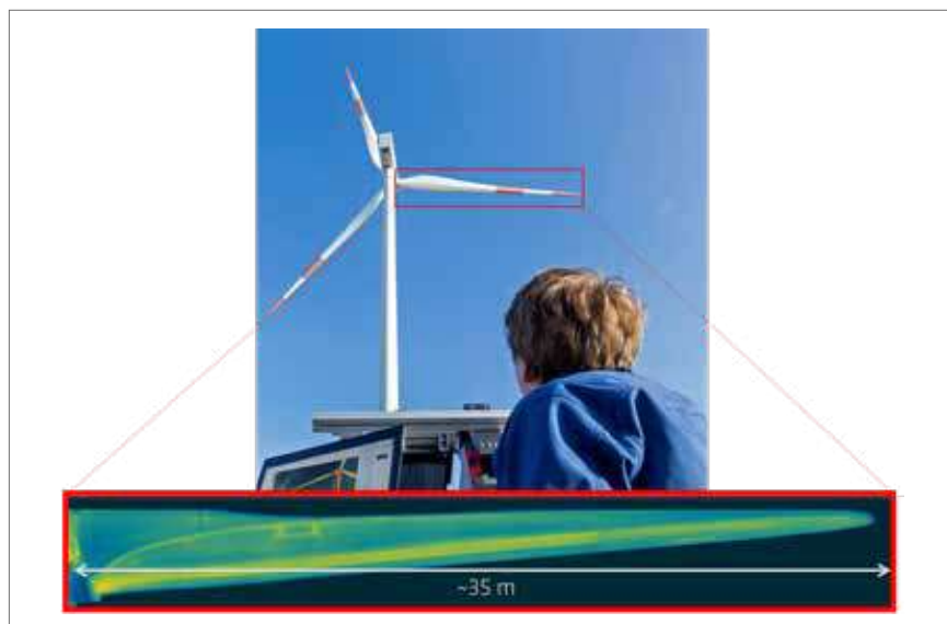
Abb. 1: Visualisierung der inneren Struktur basierend auf der thermischen Inspektion rotierender Rotorblätter. Quelle: BAM
