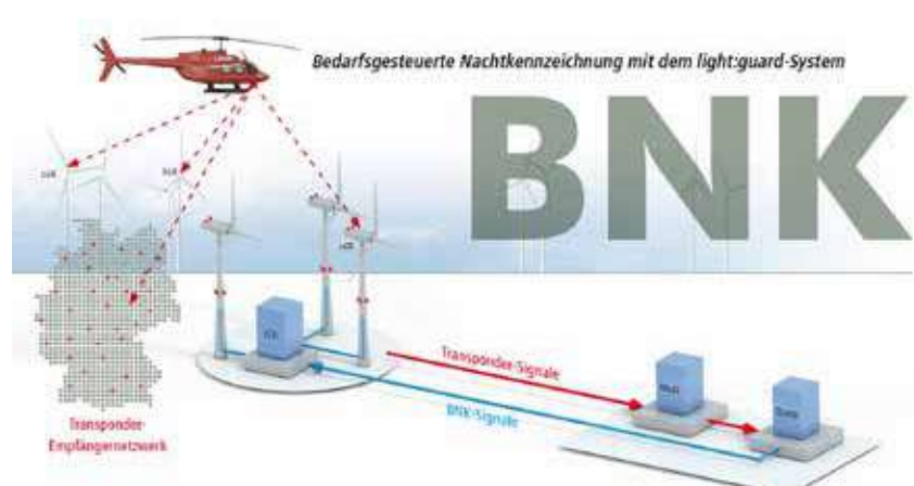
Funktionsweise des light:guard-Systems zur Bedarfsgesteuerten Nachtkennzeichnung
