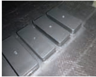
Abb.4 : Ausgleichsgewichte im Rotorblatt
